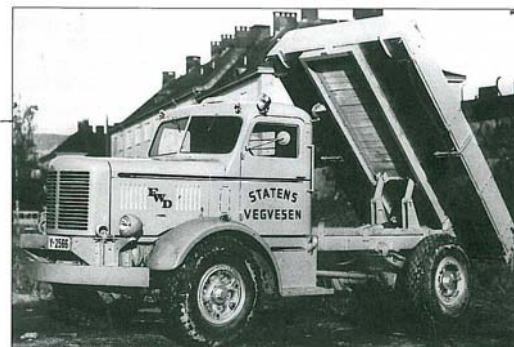
FWD lastebil, 1947-modell ble stasjonert i Talvik. Bokstavene står for Four Wheel Drive, altså fire-hjuls drift. Lasteevne 4000 kg. Foto: Ulkjent.
