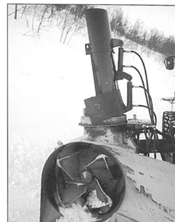
Ved å bygge om utkasteren til fresen har Jan Roald Knutsen forbedret utkastingseffekten og man unngår dessuten at utkasteren går i tet når snøen er våt.
