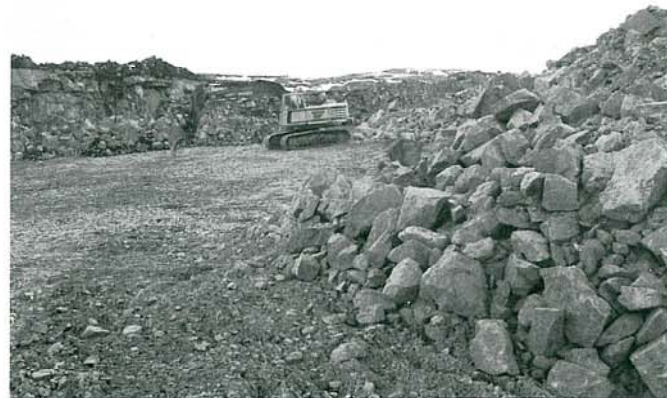
Fra dette steinbruddet tas knust steinmasse som brukes for å erstatte leirmasser.
